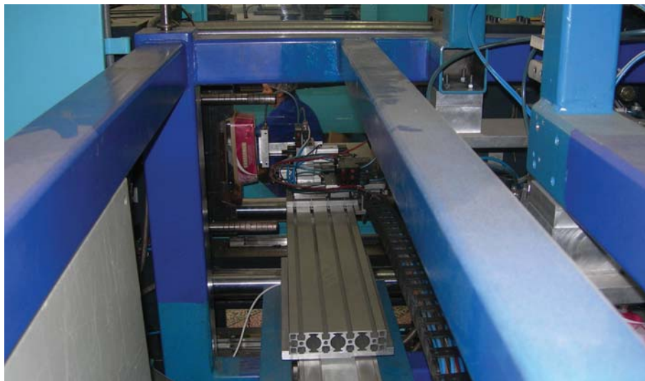
Oś numeryczna oparta na module CKR 20-145 w firmie Plastic-Form ze Świdwina
