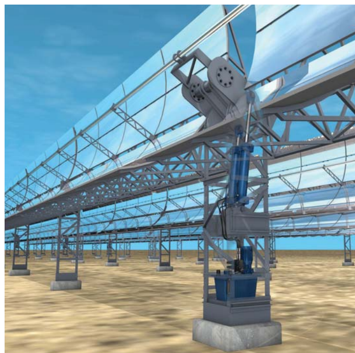
► Szczegółowy obraz rynien parabolicznych: hydraulika przemieszcza płynnie rynny paraboliczne bez efektu drgań ciernych chroniąc tym samym całą konstrukcję
