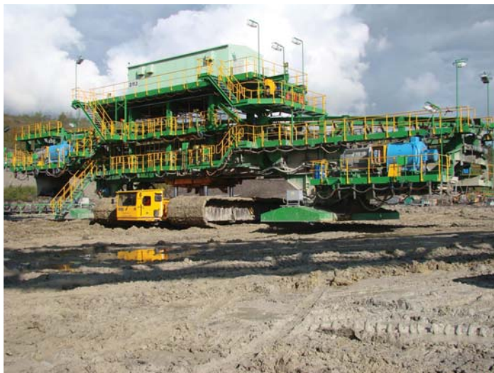
▲ Transporter w czasie przewozu stacji ważącej kilkaset ton
