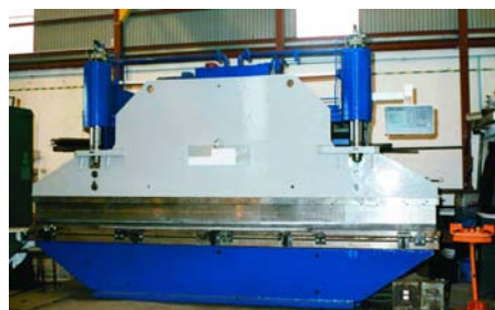
Rys. 2 Zmodernizowana prasa o nacisku 1600kN i długości cięcia 5m
