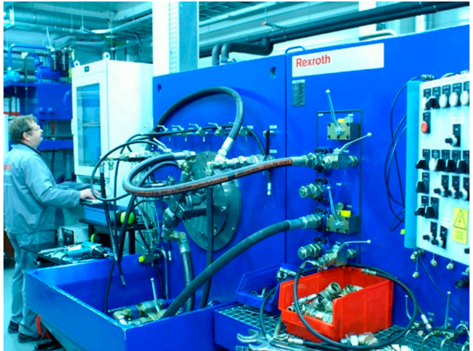
Rys. 3. Stanowisko do sprawdzania pomp i silników hydraulicznych nr 2
