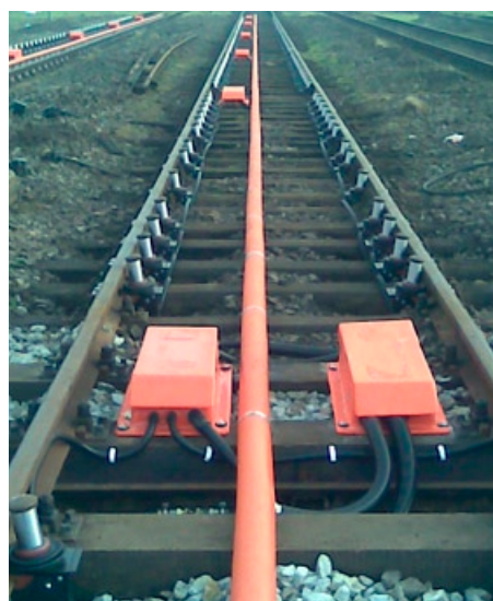
Rys. 5. Zabudowa systemów hamulcowych z magistralą zasilania i sterowania
