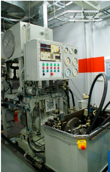
Rys. 2. Stanowisko do sprawdzania pomp i silników hydraulicznych nr 1
