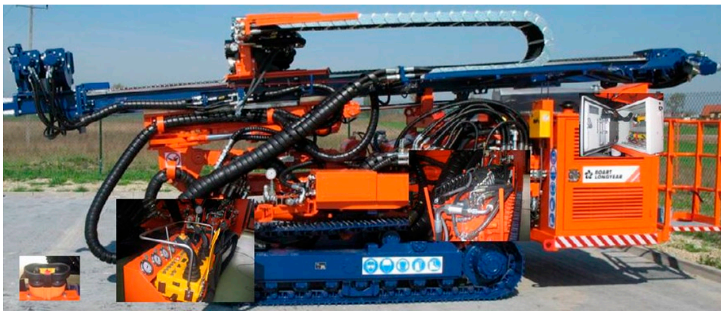
Rys. 2. Wiertnica DB102 ze sterowaniem radiowym i blokami hydraulicznymi M4-12/15 z CAN BUS
