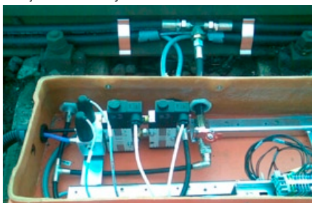
Rys. 3. Elektryczno-pneumatyczne skrzynki sterowania sekcjami hamulcowymi
