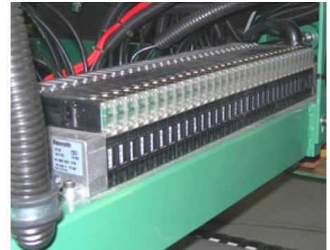
Rys. 4. Jedna z trzech wysp zaworowych HF03, na zdjęciu wyspa trzydziestodwuzaworowa
