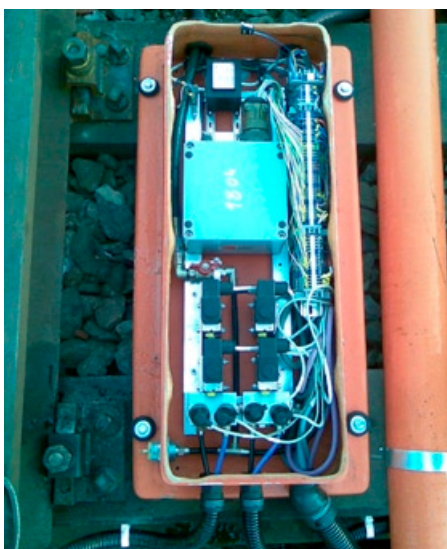
Rys. 2. Elektryczno-pneumatyczne skrzynki sterowania sekcjami hamulcowymi
