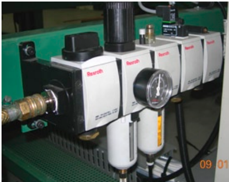
Rys. 2. Blok przygotowania sprężonego powietrza AS3
