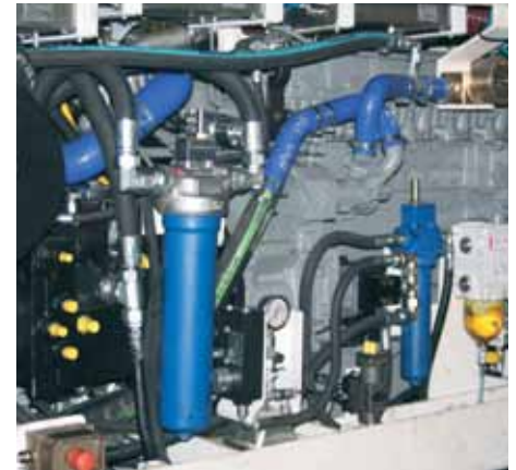
▲ Zespół pomp A4VGA... + PGH... zamontowany na silniku Diesla
