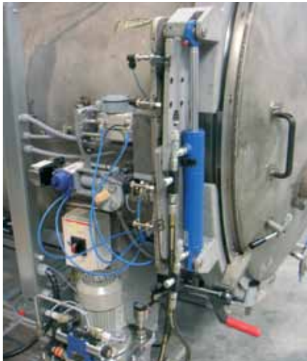
▲ Napęd hydrauliczny blokady drzwi
