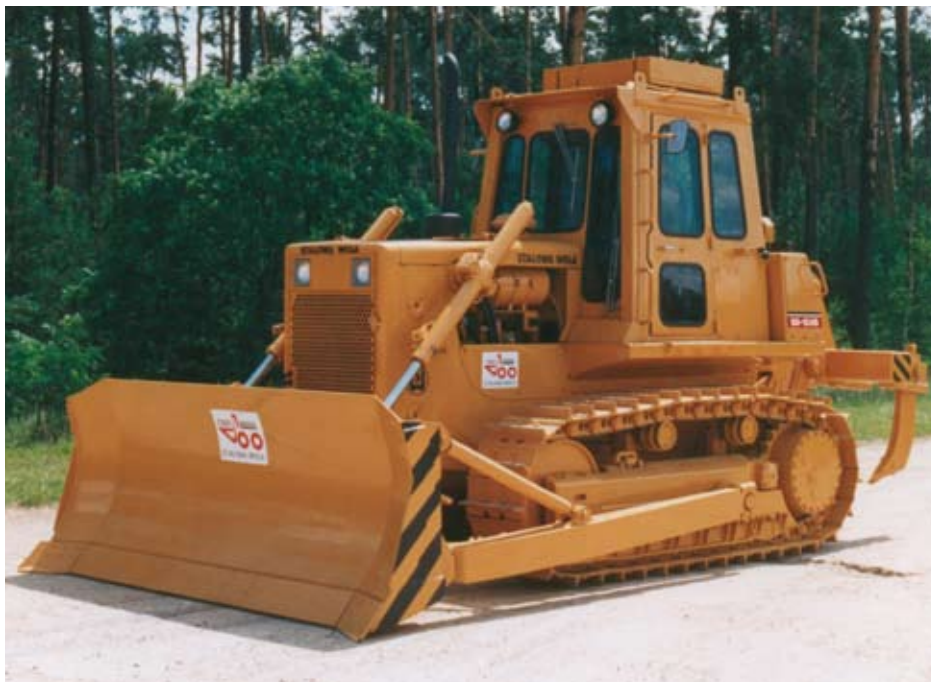
Rys. 1. Spycharka z napędem hydrostatycznym SG15HS - HSW
