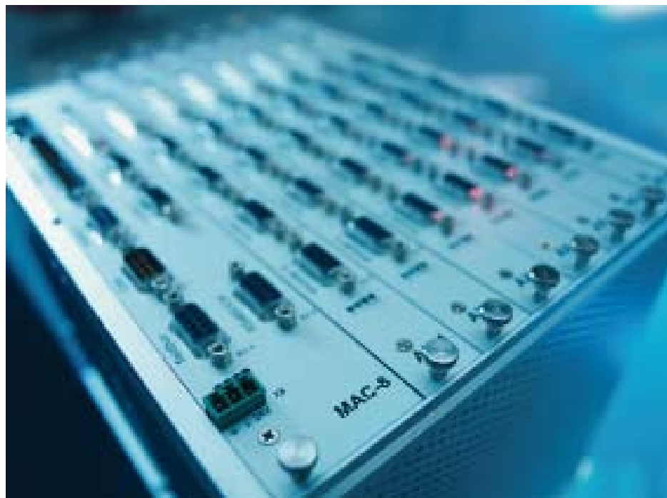
Rys. 2. Sterownik MAC-8 z możliwością sterowania 32 osiami
