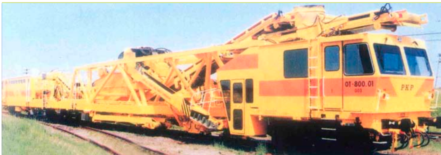
▲ Oczyszczarka tłucznia OT-800 wyprodukowana w Zakładach Naprawczych Taboru Kolejowego w Stargardzie Szczecińskim
