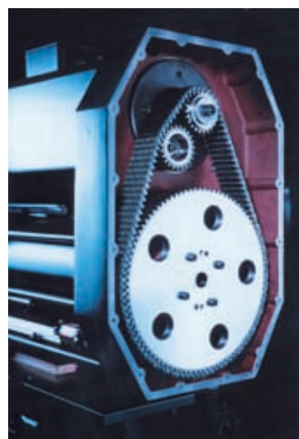
▲ Transportowe ◀ i napędowe łańcuchy zębate Rexroth
