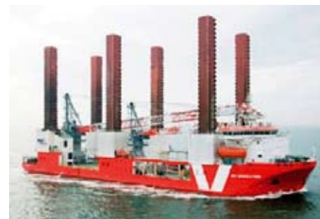
▲ Statek do obsługi elektrowni wiatrowych z systemem „jack-up”
