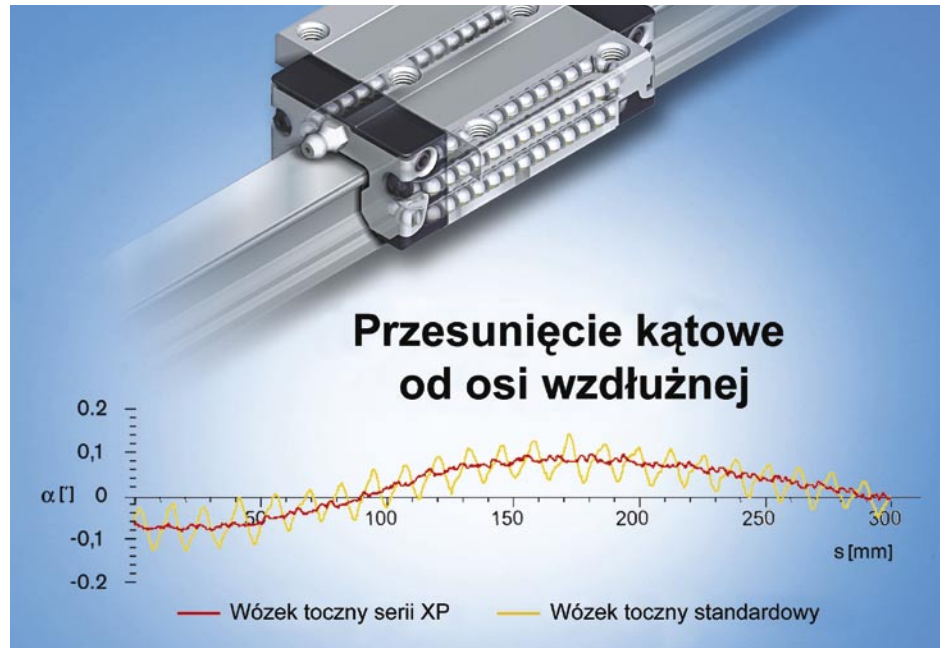
Rys. 1. Opatentowana optymalizacja Rexroth powoduje, że siły powstałe w kulkach tłumione są w strefie wejścia kulek w kanał nawrotny i kierowane do korpusu wózka tocznego. Pulsacje powstałe przy zmianie kierunku kulek (nawrót) redukowane są do wartości szczytowych w porównaniu z wartościami w dotychczasowych wykonaniach seryjnych.
