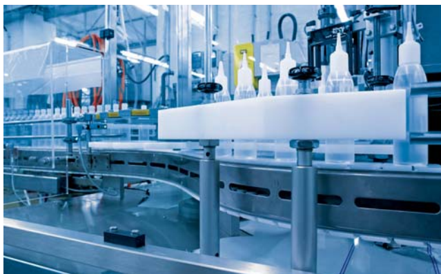
System przenośnikowy VarioFlow wykonany ze stali nierdzewnej i gwarantujący zachowanie standardów higienicznych niezawodnie transportuje puste butelki do szamponu po dowolnie ukształtowanej trasie do stanowiska napełniania i szczelnego zamykania.
