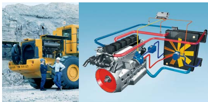
▲ Regulowany hydrostatyczny napęd wentylatora pomaga sprostać surowym normom emisji spalin
