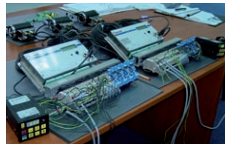
Rys. 6. System Marex OS II dla klienta z Rygi podczas wstępnego programowania w Biurze Regionalnym w Gdańsku
